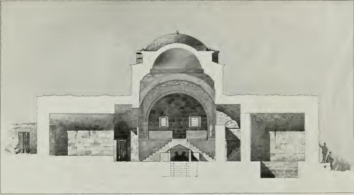
Abb. 14. Querschnitt durch die Grabkirche. 1:200.
